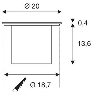
Die Bodeneinbauleuchte ROCCI 200 mit eckiger bzw. runder Edelstahlblende und klarer Glasabdeckung ist mit einem LED Modul ausgestattet. Durch die Schutzart IP67 ist die mit zwei Blendenformen verfügbare Leuchte für den Außenbereich geeignet. Der elektrische Anschluss erfolgt direkt an 230V Netzspannung. Zur einfachen Montage befindet sich ein Einbautopf im Lieferumfang.
