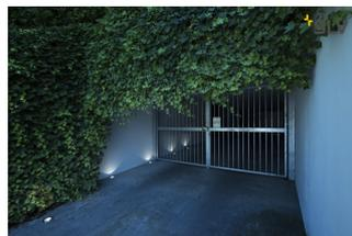
Die begehbare Hochvolt Bodeneinbauleuchte mit runder Edelstahlblende und teilsatinierter Glasabdeckung ist mit einer dreh- und schwenkbaren GU10 Fassung ausgestattet und somit kompatibel mit Halogen-, bzw. LED Lampen. Durch die Schutzart IP67 ist die Leuchte für den Außenbereich geeignet. Der elektrische Anschluss erfolgt direkt an 230V Netzspannung. Zur einfachen Montage befindet sich ein Einbautopf im Lieferumfang.+
