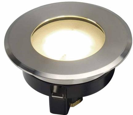
Die Hochvolt Bodeneinbauleuchte DASAR FLAT 80 mit runder Edelstahlblende und satiniertes Glasabdeckung ist mit einem leistungsstarken PowerLED Modul ausgestattet. Durch die Schutzart IP67 ist die in zwei Lichtfarben verfügbare Leuchte für den Außenbereich geeignet. Der elektrische Anschluss erfolgt mittels verbauter Zuleitung direkt an 230V Netzspannung. Zur einfachen Montage befindet sich ein Einbautopf im Lieferumfang. Die Lampen können in der Leuchte nicht ausgetauscht werden.
