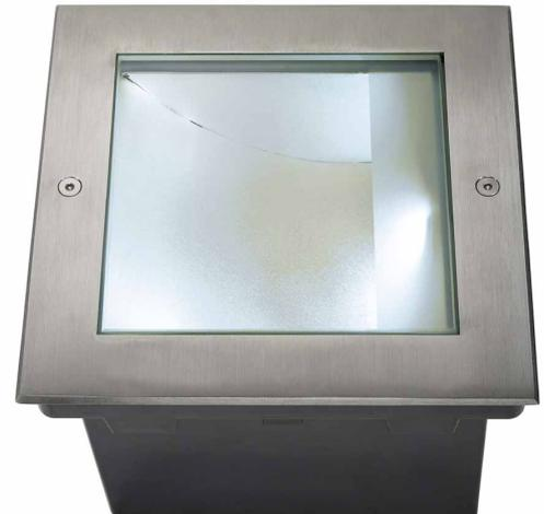
Die Hochvolt LED Bodeneinbauleuchte DASAR 225 mit quadratischer Edelstahlblende und teilsatinierter Glasabdeckung ist mit einem Hochleistungs LED Modul des Herstellers Philips ausgestattet. Durch die Schutzart IP67 und den indirekten Lichtaustritt ist Leuchte für Außenanwendung geeignet. Der elektrische Anschluss erfolgt durch den verbauten Treiber direkt an 230V Netzspannung. Zur einfachen Montage befindet sich ein Einbautopf im Lieferumfang.
