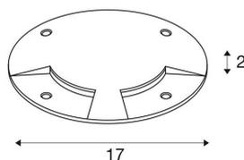
Das LED PLOT Modul dient der Effekt- und Orientierungsbeleuchtung im Außenbereich. Dank der aus Edelstahl 316 hergestellten BIG PLOT Abdeckung sind stimmungsvolle Lichteffekte möglich. In Edelstahl überzeugt die dekorative Komponente durch ihre hochwertige Qualität. Dazu schützt sie die Schutzart IP 20 optimal.
