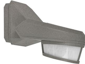
Bewegungsmelder mit Unterkriechschutz, potentialfreiem Schaltausgang und intelligenter Kleintier-Toleranz. 300° Erfassungsbereich für Montage an Aussenecke. Dreh- und neigbarer Sensorkopf für optimale Einstellung. Einfache Verdrahtung auf Sockel, Melder zum Aufklicken.
