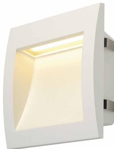
Aus Aluminium gefertigte, mit leistungsstarken SMD LEDs bestückte DOWNUNDER OUT LED L Wandeinbauleuchten Serie mit indirektem, nach unten gerichtetem, blendfreiem Lichtaustritt. Durch die Schutzart IP55 ist die Leuchte für den Außenbereich geeignet. Der elektrische Anschluss der Leuchte erfolgt direkt an 230V Netzspannung. Zur einfachen Montage befindet sich ein Einbautopf im Lieferumfang.
