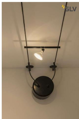
Schwenkbarer Strahler COSMIC für das Niedervolt Seil-System. Durch den verbauten GX5,3 Sockel ist der Strahler für Halogen- sowie LED-Leuchtmittel geeignet. Der kompatible Seilabstand beträgt 15,5cm.
