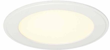
Die SENSER 18 Einbauleuchte aus Aluminium ist erhältlich in den Farben weiß und silbergrau sowie mit runder- und eckiger Blende. Der starre Premium LED-Einsatz ermöglicht durch den Abstrahlwinkel von 120° eine flächige, homogene Grundbeleuchtung. Zum Betrieb der Einbauleuchte wird ein passender Konstantstromtreiber mit 350mA benötigt.
