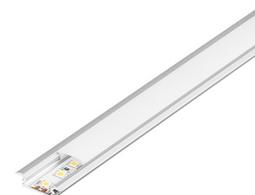
Ultraflaches, aluminium eloxiertes GLENOS Linear-Einbau-Profil 2508 mit Rand in 1 m Länge exklusive Abdeckung zur Montage von LED Strips bis 12 mm Breite.
