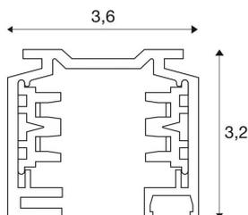
Aluminium Trägerschiene des EUTRAC Hochvolt 3Phasen-Aufbauschiene-Systems. Die Montage kann durch die im Profil vorhandenen Bohrungen direkt an Wand oder Decke erfolgen. Die Aufbauversion dieses Systems ist in mehreren Farben und Längen verfügbar. Alternativ steht des Weiteren eine Einbauversion zur Verfügung.
