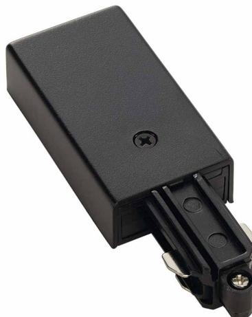
Endeinspeiser für das Hochvolt 1Phasen-Aufbauschienen-System. Der in mehreren Farbversionen verfügbare Einspeiser ist mit Erdleiter links oder rechts erhältlich. Detaillierte Informationen entnehmen Sie bitte der Planungshilfe.
