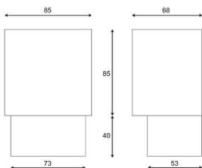
Einbaudose für FLAT FRAME BASIC, FRAME BASIC, FLAT FRAME CURVE und FRAME CURVE Einbaustrahler.
