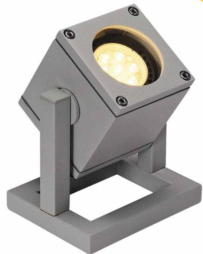
Mobile Aluminiumleuchte CUBIX 1 die durch Schutzart IP44 für den Außenbereich geeignet ist. Der am Rahmen montierte Leuchtenkopf ist zur optimalen Ausleuchtung schwenkbar. Der elektrische Anschluss der Leuchte erfolgt mittels verbauter Zuleitung inkl. Netzstecker direkt an 230V Netzspannung.+
