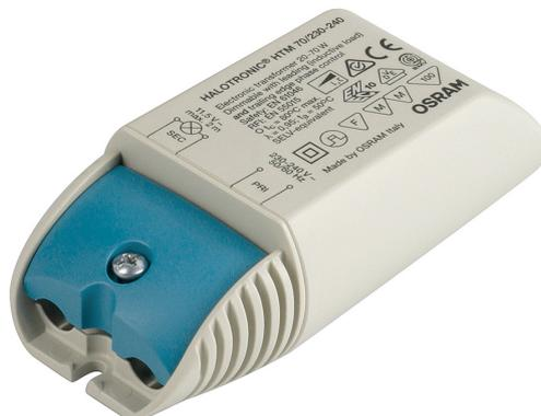
Produkteigenschaften: Netzfrequenz: 50-60 Hz, Funkentstörung: nach EN 55015 (A1: 2007)/ CISPR 15, EN 55022, Netzstromoberwellen: nach EN 61000-3-2, Immunität, Störfestigkeit: nach EN 61547, Sicherheit: nach EN 61347, Galvanische Trennung zwischen Primär- und Sekundärseite, Kurzschlusschutz, Überlastschutz, Übertemperaturschutz: elektronisch reversibel.
