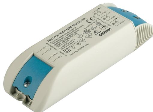
Produkteigenschaften: Netzfrequenz: 50-60 Hz, Funkentstörung: nach EN 55015 (A1: 2007)/ CISPR 15, EN 55022, Netzstromoberwellen: nach EN 61000-3-2, Immunität, Störfestigkeit: nach EN 61547, Sicherheit: nach EN 61347, Galvanische Trennung zwischen Primär- und Sekundärseite, Kurzschlusschutz, Überlastschutz, Übertemperaturschutz: elektronisch reversibel
