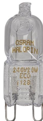
HALOPIN Lampen sind die Lösung für filigrane, kompakt aufgebaute Halogenleuchten. Aufgrund ihrer geringen Abmessungen und da kein Trafo in die Konstruktion einbezogen werden muss, bieten sie mehr Freiheit im Design. Mittlere Lebensdauer: 2.000 h, Dimmbar, Farbwiedergabeindex Ra: 100, Socket: G9. Der gewichtete Verbrauch liegt bei 33kWh/1000h.
