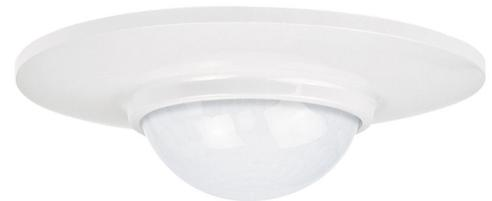
Master/Slave-Präsenzmelder für den universellen Einsatz dank vielseitigem Zubehör. Konstantlichtregelung für 2 Zonen, 1 sekundäre Zone (ON/OFF), HLK, Helligkeitsschwelle und Nachlaufzeit im Betrieb veränderbar, Standby-Licht, Voll- und Halbautomatikmodus.
