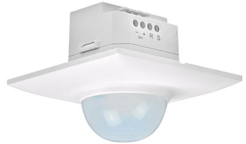
Master-Präsenzmelder zur Ansteuerung von Leuchten mit 1 bis 10 V Schnittstelle. Bei Abwesenheit werden die Leuchten über den integrierten Schaltkontakt vom Netz getrennt, minimaler Standby-Verbrauch. Bereichserweiterung mit max. 10 Slave-Meldern. Externer Taster (ON/OFF).
