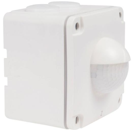
Master/Slave-Präsenzmelder, Wandmontage von 1,0 bis 3,0 m möglich dank horizontalem und vertikalem Erfassungsbereich, Konstantlichtregelung für 2 Zonen, 1 sekundäre Zone (ON/OFF), HLK, Helligkeitsschwelle und Nachlaufzeit im Betrieb veränderbar, Standby-Licht, Voll- und Halbautomatikmodus.
