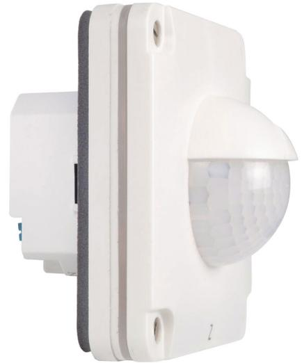
Master/Slave-Präsenzmelder, Wandmontage von 1,0 bis 3,0 m möglich dank horizontalem und vertikalem Erfassungsbereich, Konstantlichtregelung für 2 Zonen, 1 sekundäre Zone (ON/OFF), HLK, Helligkeitsschwelle und Nachlaufzeit im Betrieb veränderbar, Standby-Licht, Voll- und Halbautomatikmodus.
