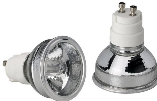
GE ConstantColor CMH Leuchtmittel kombinieren HPS Technologie (Bereitstellung von Stabilität, Effizienz und Einheitlichkeit) und Halogenmetaldampf Technologie (Bereitstellung von hellem, weißen Licht) zu einer hoch effizienten Lichtquelle mit guter Farbwiedergabe über die gesamte Lebensdauer. Diese Eigenschaften werden durch die Verwendung von Keramikbrennern aus der Lucalox Lampe erreicht, welche die chemischen Veränderungen innerhalb der Lampe über die gesamte Lebensdauer minimiert.
