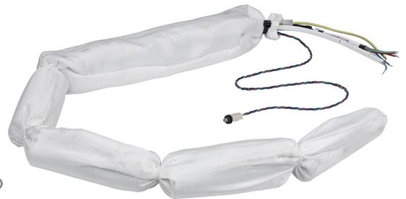
3 Stunden Emergency Pack. Umrüstung dimmbarer und nicht dimmbarer LED Downlights bis zu 10W. LED-Treiber und NiMH-Batterie in einer Netzhülle enthalten. Kann nachträglich in vorhandene Installationen eingebaut werden.
