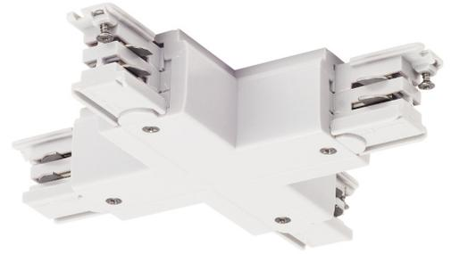
X-Verbinder mit Einspeisemöglichkeit für das Hochvolt 3Phasen-Aufbauschienen-System. Der in mehreren Farbversionen verfügbare Verbinder verfügt über zwei getrennte Stromkreise. Detaillierte Informationen entnehmen Sie bitte der Planungshilfe. Bitte beachten Sie, dass sich der Weißton ab dem 01. Oktober 2018 von RAL 9010 auf RAL 9016 (Verkehrsweiß) ändert.
