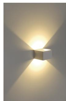
Die markante LED UP/DOWN Wandaufbauleuchte LOGS IN verfügt über eine hochmoderne, leistungsstarke COB LED welche ihr warmweißes Licht indirekt abgibt. Somit eignet sie sich hervorragend zur blendfreien Beleuchtung von Treppen, Aufgängen und Räumen. Durch den in die Rosette integrierten Konstantstromtreiber kann der elektrische Anschluss direkt an 230V Netzspannung erfolgen.
