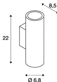
Die puristische Wandanbauleuchte ENOLA\_B besteht aus einer Aluminium / Stahl Konstruktion und ist wahlweise verfügbar in den Gehäusefarben schwarz, weiß, messing und silbergrau. Dank der Position der zwei verbauten Fassungen, erzeugt die montierte Leuchte zwei gleiche, jedoch entgegengesetzte Lichtkegel (UP/DOWN) der zum Einsatz gebrachten Hochvolthalogenleuchtmittel des Typs GU10. ENOLA\_B ist fertig für den direkten Anschluss an 230V Netzspannung.
