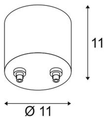
Dimmbarer, konventioneller 12V Niedervolttransformator in ansprechendem Design mit direktem Niedervoltanschluss sowie einer maximalen Leistung von 105W. Erhältlich in mehreren Farbvarianten.
