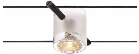
Aus Stahl und teilsatiniertem Glas bestehende Strahler COMET für das Niedervolt Seil-System. Durch den verbauten GU5,3 Sockel ist der Strahler für Halogen- sowie LED-Leuchtmittel geeignet. Der maximal kompatible Seilabstand beträgt 15,5cm.
