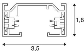
Aluminium Trägerschiene des 1Phasen Hochvolt Aufbauschiensystems. Die Montage kann durch die im Profil vorhandenen Bohrungen direkt an Wand oder Decke erfolgen. Die Aufbauversion dieses Systems ist in mehreren Farbversionen verfügbar. Alternativ steht des Weiteren eine Einbauversion zur Verfügung.
