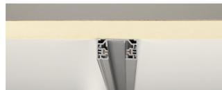
Aluminium Trägerschiene des 1Phasen Hochvolt Aufbauschiene-Systems. Die Montage kann durch die im Profil vorhandenen Bohrungen direkt an Wand oder Decke erfolgen. Die Aufbauversion dieses Systems ist in mehreren Farbversionen verfügbar. Alternativ steht des Weiteren eine Einbauversion zur Verfügung.
