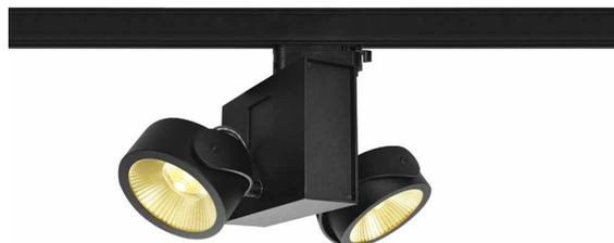
Die futuristische Hochvolt TEC KALU mit passendem Adapter für das 3Phasen Hochvolt-Schienen-System verfügt über individuell dreh- und schwenkbare Leuchtenköpfe bestückt mit warmweißen und dimmbaren Premium LED. Der bereits eingebaute, LED Treiber befindet sich innerhalb der Mittelkonstruktion. TEC KALU wird fertig für den direkten Anschluss an 230V Netzspannung geliefert.
