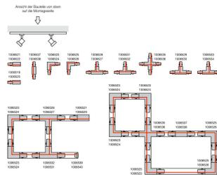
T-Verbinder für das S-TRACK Hochvolt 3Phasen-Einbauschienen-System. Der Verbinder ist mit Erdleiter außen links in den Farben weiß und schwarz erhältlich. Detaillierte Informationen entnehmen Sie bitte der Planungshilfe.
