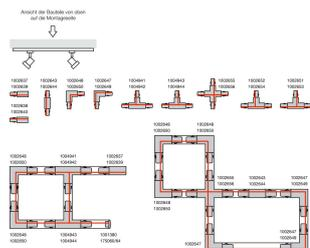
DALI kompatibler, T-Verbinder mit Einspeisemöglichkeit für das Hochvolt 3Phasen-Aufbauschienen-System. Der in mehreren Farbversionen verfügbare Verbinder ist mit Erdleiter innen oder außen erhältlich. Detaillierte Informationen entnehmen Sie bitte der Planungshilfe.
