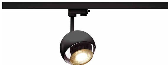
Dreh- und schwenkbarer Hochvoltstrahler LIGHT EYE 150 mit passendem Adapter für das 3Phasen Hochvolt-Schienen-System. Die kugelförmige, aus Stahl gefertigte Leuchte ist durch den verbauten GU10 Sockel für Halogen- sowie LED-Leuchtmittel mit einem Durchmesser von 11,1cm geeignet.+
