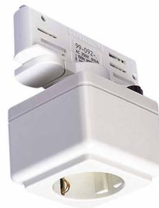
Schienensteckdose für das Hochvolt 3Phasen-Schienen-System. Die in mehreren Farbversionen verfügbare Steckdose ist für den Anschluss von Geräten der Schutzklasse I (System Schuko) bzw. der Schutzklasse II geeignet. Neben einer trägen 6,3A Sicherung verfügt die Schienensteckdose des Weiteren über eine Einspeisemöglichkeit. Bitte beachten Sie, dass sich der Weißton ab dem 01. April 2018 von RAL 9010 auf RAL 9016 (Verkehrsweiß) ändert.
