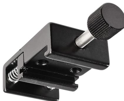
Gerade im Messebau, wo Stromschienen häufig montiert und demontiert werden, ist die Schnellmontageklammer die perfekte Montagehilfe. Die Stromschiene wird mit der Federklammer eingeklickt und werkzeuglos mittels Rändel-schraube fixiert. Noch nie war die Stromschienenmontage schneller.
