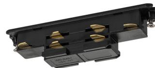
DALI kompatibler, starrer Verbinder für das Hochvolt 3Phasen-Aufbauschiene-System. Bei abgehängter Montage aus statischen Gründen nur in Verbindung mit Stoßstellenverbinder einsetzbar.
