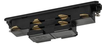
DALI kompatibler, starrer Verbinder für das Hochvolt 3Phasen-Aufbauschiene-System. Bei abgehängter Montage aus statischen Gründen nur in Verbindung mit Stoßstellenverbinder einsetzbar.
