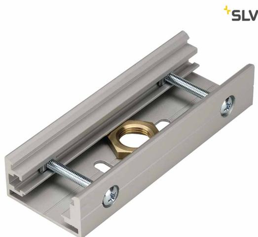
Mechanischer Stoßstellenverbinder für das Hochvolt 3Phasen-Aufbauschiene-System. Der in mehreren Farbversionen erhältliche Verbinder verfügt über ein M13 Innengewinde zur Aufnahme der Seil- bzw. Pendelabhängung.
