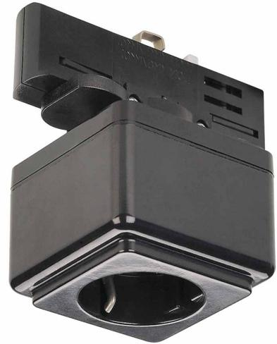
Schienensteckdose für das Hochvolt 3Phasen-Schienen-System. Die in mehreren Farbversionen verfügbare Steckdose ist für den Anschluss von Geräten der Schutzklasse I (System Schuko) bzw. der Schutzklasse II geeignet. Neben einer trägen 6,3A Sicherung verfügt die Schienensteckdose des Weiteren über eine Einspeisemöglichkeit.
