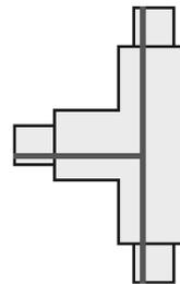
T-Verbinder mit Einspeisemöglichkeit für das Hochvolt 3Phasen-Aufbauschiene-System. Der in mehreren Farbversionen verfügbare Verbinder ist mit Erdleiter links oder rechts erhältlich. Detaillierte Informationen entnehmen Sie bitte der Planungshilfe.
