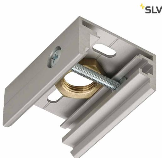
Pendelclip für das Hochvolt 3Phasen-Aufbauschiene-System. Der in mehreren Farbversionen erhältliche Verbinder verfügt über ein M13 Innengewinde zur Aufnahme der Seil- bzw. Pendelabhängung.
