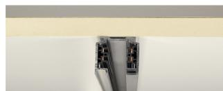
Aluminium Trägerschiene des EUTRAC Hochvolt 3Phasen-Aufbauschiene-Systems. Die Montage kann durch die im Profil vorhandenen Bohrungen direkt an Wand oder Decke erfolgen. Die Aufbauversion dieses Systems ist in mehreren Farben und Längen verfügbar. Alternativ steht des Weiteren eine Einbauversion zur Verfügung.
