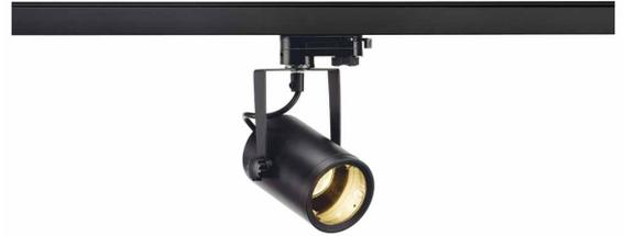
Dreh- und schwenkbarer Hochvoltstrahler EURO SPOT mit passendem Adapter für das 3Phasen Hochvolt-Schienen-System. Durch den im zylindrischen Aluminium Leuchtenkopf verbauten GU10 Sockel ist die Leuchte für Halogen- und LED-Leuchtmittel mit einem Durchmesser von bis 5 cm geeignet.+
