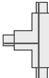
T-Verbinder mit Einspeisemöglichkeit für das Hochvolt 3Phasen-Aufbauschiensystem. Der in mehreren Farbversionen verfügbare Verbinder ist mit Erdleiter links oder rechts erhältlich. Detaillierte Informationen entnehmen Sie bitte der Planungshilfe. Bitte beachten Sie, dass sich der Weißton ab dem 01. April 2018 von RAL 9010 auf RAL 9016 (Verkehrsweiß) ändert.
