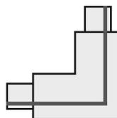
Eckverbinder mit Einspeisemöglichkeit für das Hochvolt 3Phasen-Aufbauschiene-System. Der in mehreren Farbversionen verfügbare Verbinder ist mit Erdleiter links oder rechts erhältlich. Detaillierte Informationen entnehmen Sie bitte der Planungshilfe.
