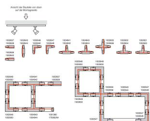
Die neuen verstellbaren T-Verbinder machen die Planung eines S-TRACK-Aufbauschiensystem noch einfacher. Da sie für Erde innen und außen verstellbar sind, lässt sich das Schienenlayout noch müheloser konfigurieren. Aus zwei Produkten wird jetzt eins – das macht nicht nur die Planung leichter, sondern spart auch Platz in Ihrem Lager.
