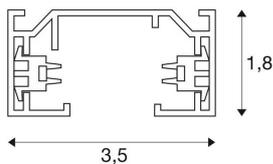
Aluminium Trägerschiene des 1Phasen Hochvolt Aufbauschiene-Systems. Die Montage kann durch die im Profil vorhandenen Bohrungen direkt an Wand oder Decke erfolgen. Die Aufbauversion dieses Systems ist in mehreren Farbversionen verfügbar. Alternativ steht des Weiteren eine Einbauversion zur Verfügung.
