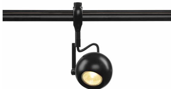
Dreh- und schwenkbarer Hochvoltstrahler LIGHT EYE mit passendem Adapter für das EASYTEC II Schienen-System. Die kugelförmige, aus Stahl gefertigte Leuchte ist durch den verbauten GU10 Sockel für Halogen- sowie LED-Leuchtmittel mit einem Durchmesser von 5 cm geeignet.
