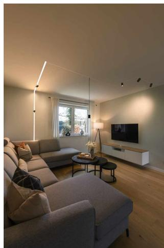
Schlichte Linearleuchten für einen besonders eleganten Look: Die IN-LINE Strahler lassen sich so im 48V TRACK Schienensystem verstecken, dass nur das Beste zum Vorschein kommt: Hochwertiges Licht mit einem Abstrahlwinkel von 35° in verschiedenen Lumen-Stärken, einer via CCT-Switch einstellbaren Lichtfarbtemperatur (2700K/3000K/4000K) und naturgetreuen Farbwiedergabe (CRI>90). Dazu ist die DALI-kompatible IN-LINE Linearleuchte auch noch so schnell wie einfach via Schienenadapter installiert.
